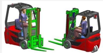
**车与车安全防护：**两辆叉车上都装有行人安全辅助系统（设备/标签），当车与车靠近时，叉车可实现在相应设定距离下的报警、减速或紧急制动以防止车车相撞。
