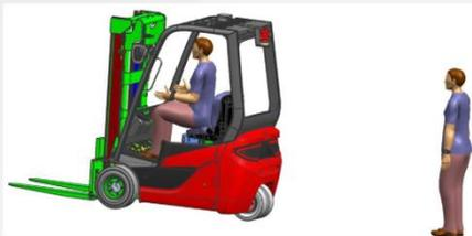
**人与车安全防护：**行人佩戴标签，叉车上安装行人安全辅助系统，当行人靠近叉车时，叉车可实现在相应设定距离下的报警、减速或紧急制动以保护行人安全。
