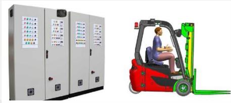
**设备与车安全防护：**设备上固定行人标签，叉车上安装行人安全辅助系统，当叉车靠近设备时，叉车可实现在相应设定距离下的报警、减速或紧急制动以防止叉车与设备相撞。
