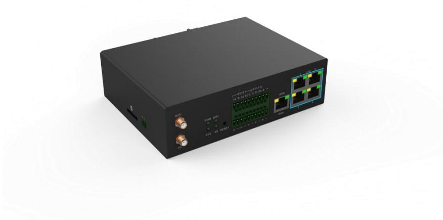
工业级通讯网关是一款工业级多业务物联网无线路由器，设计完全满足工业级标准和工业用户的需求，采用高性能的工业级 32 位通信处理器，软件多级检测和硬件多重保护机制来提高设备稳定性。支持中国电信 4G，中国联通 4G/2G、中国移动 4G/2G 网络，同时支持多种 VPN 协议（OpenVPN、IPSEC、PPTP、L2TP 等）来保证数据传输的安全性。支持 5 口千兆以太网接口和 2.4G Wifi 功能，支持 SUBG 无线通讯，最大支持 32/64 个 UWB 基站，内置位置数据过滤算法。同时支持 RS232、RS485 数据接口、IO 接口，满足不同设备的数据接入及控制。
