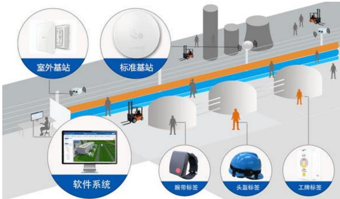
定位系统由数据采集端、服务器端、客户端共同组成，通过三个部分的有机结合，分别实现定位数据的采集上传、定位数据解算、定位数据展示等。
