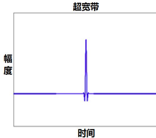
UWB 信号的时域波形如上图所示。不同于传统的无线射频信号有固定频率的载波（如蓝牙 2.4G），UWB 在不发送数据时是完全静态的，要发送数据时才发送宽度很窄（如 1ns）的脉冲信号。该窄脉冲在频域上很宽，所以叫超宽带。因为 UWB 时域信号脉冲较窄，所以在时间、空间上有较大分辨力，比较容易抵抗室内信号传输常见的多径效应（信号因为反射造成的多路径传播）的影响，因此测距和定位精度较高。
