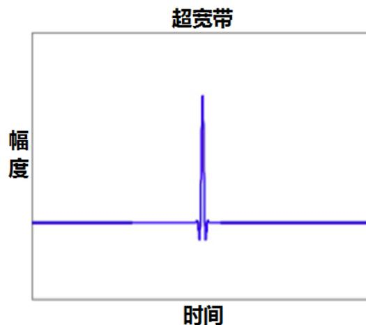
UWB 信号的时域波形如上图所示。不同于传统的无线射频信号有固定频率的载波（如蓝牙 2.4G），UWB 在不发送数据时是完全静态的，要发送数据时才发送宽度很窄（如 1ns）的脉冲信号。该窄脉冲在频域上很宽，所以叫超宽带。因为 UWB 时域信号脉冲较窄，所以在时间、空间上有较大分辨力，比较容易抵抗室内信号传输常见的多径效应（信号因为反射造成的多路径传播）的影响，因此测距和定位精度较高。
